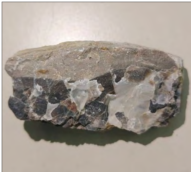
FIGURA 2. campione di roccia carbonatica proveniente dal Monte Bolza (MB_1).
