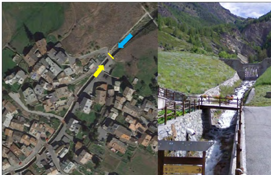
Figura 10. La sezione 3 è localizzata sul T. D'Arpison, tributario destro del T. Grand Eyovia, in corrispondenza del ponte più a monte del paese di Epinel, circa 60 m a valle della briglia selettiva costruita per difesa dalle colate detritiche
