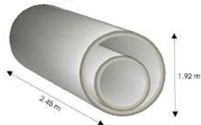
Type 3: Module Nègri Volume : 11 m 3 Weight: 8 t
