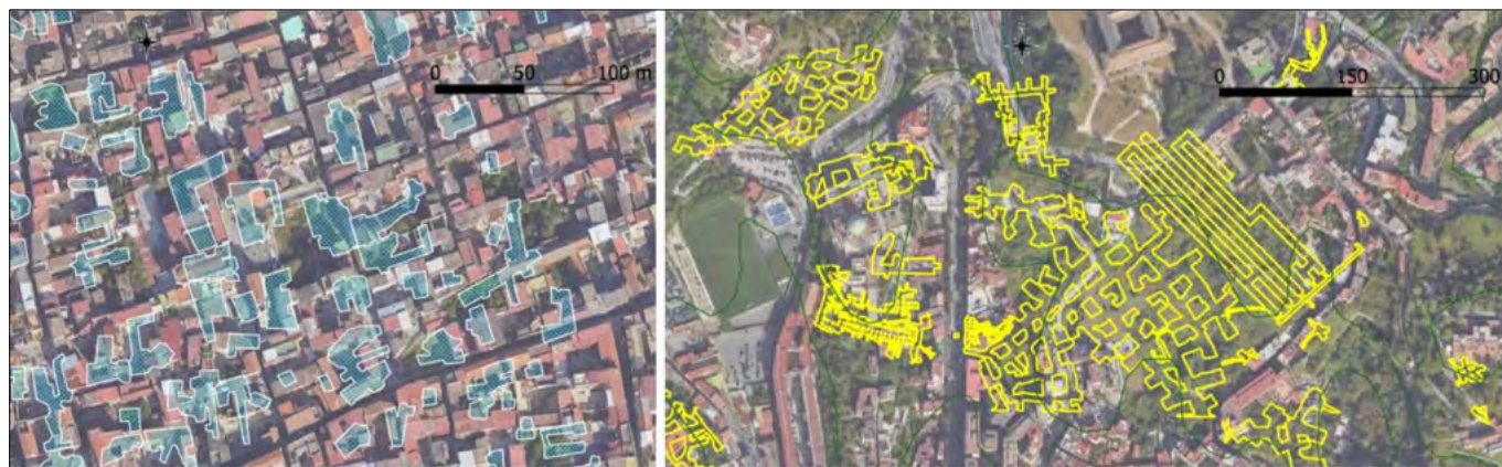
Figura 2. Dimensioni e geometria in pianta delle cavità scavate nella formazione dell'Ignimbrite Campana (a sinistra) e del Tufo Giallo Napoletano (a destra)
