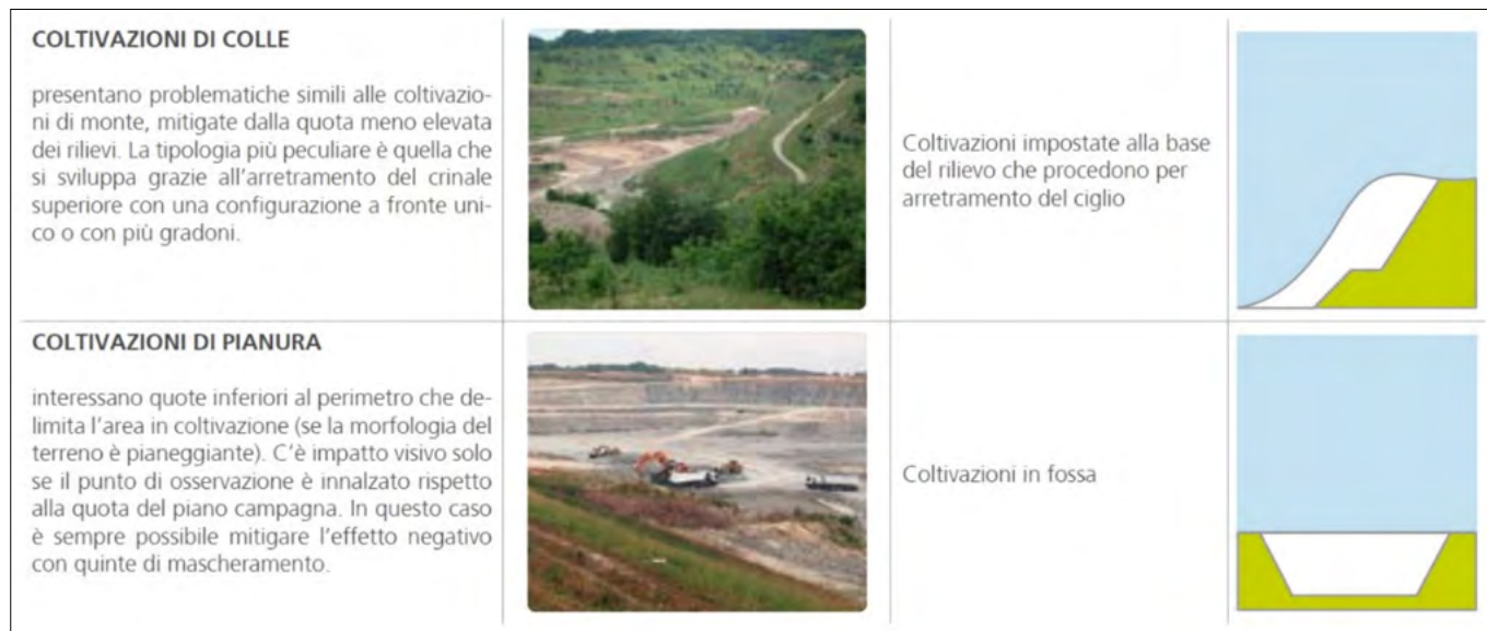
Figura 3. Schema delle principali tipologie e metodi di coltivazione utilizzati nelle cave a cielo aperto nell'area di studio (da AITEC, 2012)
