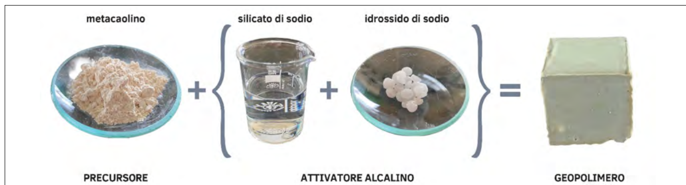
Figura 1. Il processo di preparazione di un geopolimero richiede la miscelazione meccanica di un precursore (come ad esempio il metacaolino) con una soluzione alcalina (composta ad esempio da silicato di sodio ed idrossido di sodio), in proporzioni definite. Dalla maturazione in condizioni controllate (tempo - temperatura - umidità) è possibile ottenere materiali con differenti proprietà chimico-fisiche
