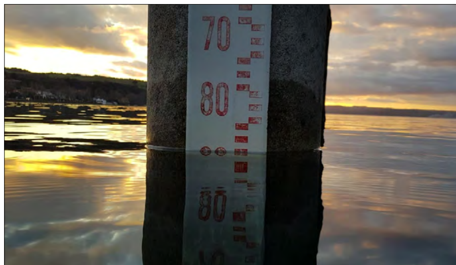
Figura 5. Stadia per la misura visiva del livello del lago presso il pontile d'attracco della motonave ad Anguillara Sabazia (Foto di Alessandro Mecali)
