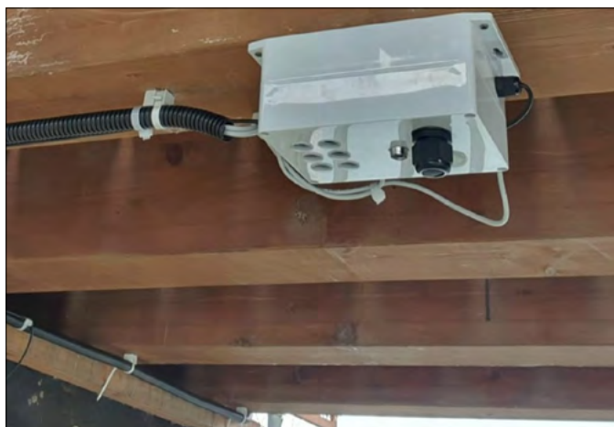
Figura 8. Sensore idrometrico a ultrasuoni installato al di sotto del Pontile degli Inglesi (sinistra) e variazione del livello del lago di Bracciano misurata tra fine dicembre 2022 e gennaio 2023. Il dato (che deve essere ancora perfezionato nella calibrazione) fa riferimento allo zero idrometrico istituzionale di 163,04 m s.l.m. (Dati Opirware. Elaborazione: ENEA)
