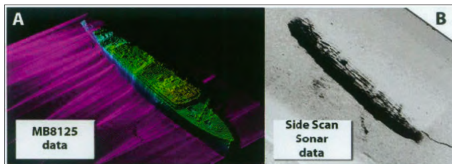
Figura 2. Immagine-dato MBES (a) e SSS (b) del relitto della Nave Po.
