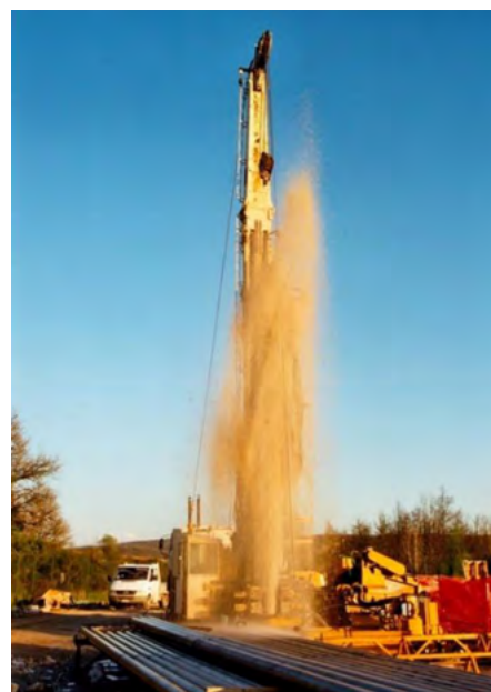
Figura 6. Perforazione di un pozzo minerario per CO 2 , eruzione incontrollata con l'espulsione del fango e dei detriti
