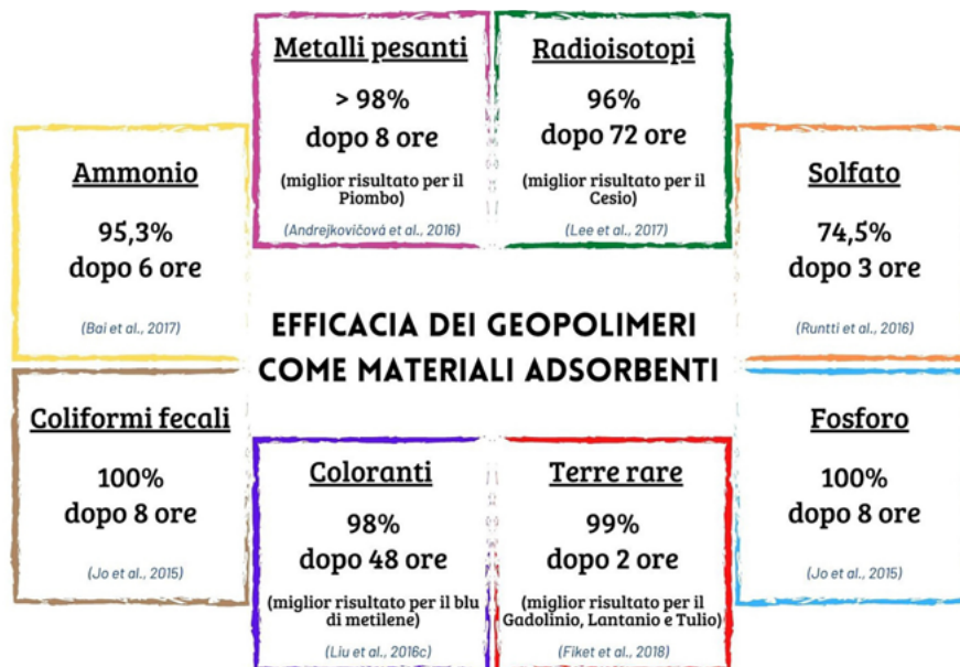
Figura 6. Efficacia dei geopolimeri come materiali adsorbenti nel trattamento delle acque reflue. Per ogni elemento è indicato il massimo valore di rimozione raggiunto ed il tempo di contatto necessario al raggiungimento dello stesso
