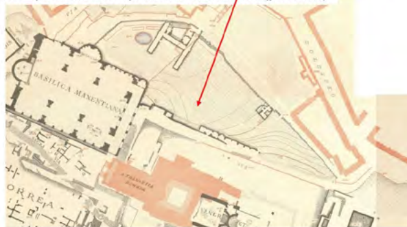
Media Pars Urbis – 1911- Rilievo planimetrico eseguito dagli allievi della R. Scuola d'applicazione per gli ingegneri in Roma con la guida dei Pof. U. Barbieri e G. Cassinis. Quote max della collina misurate: 42-43 metri s.l.m.
