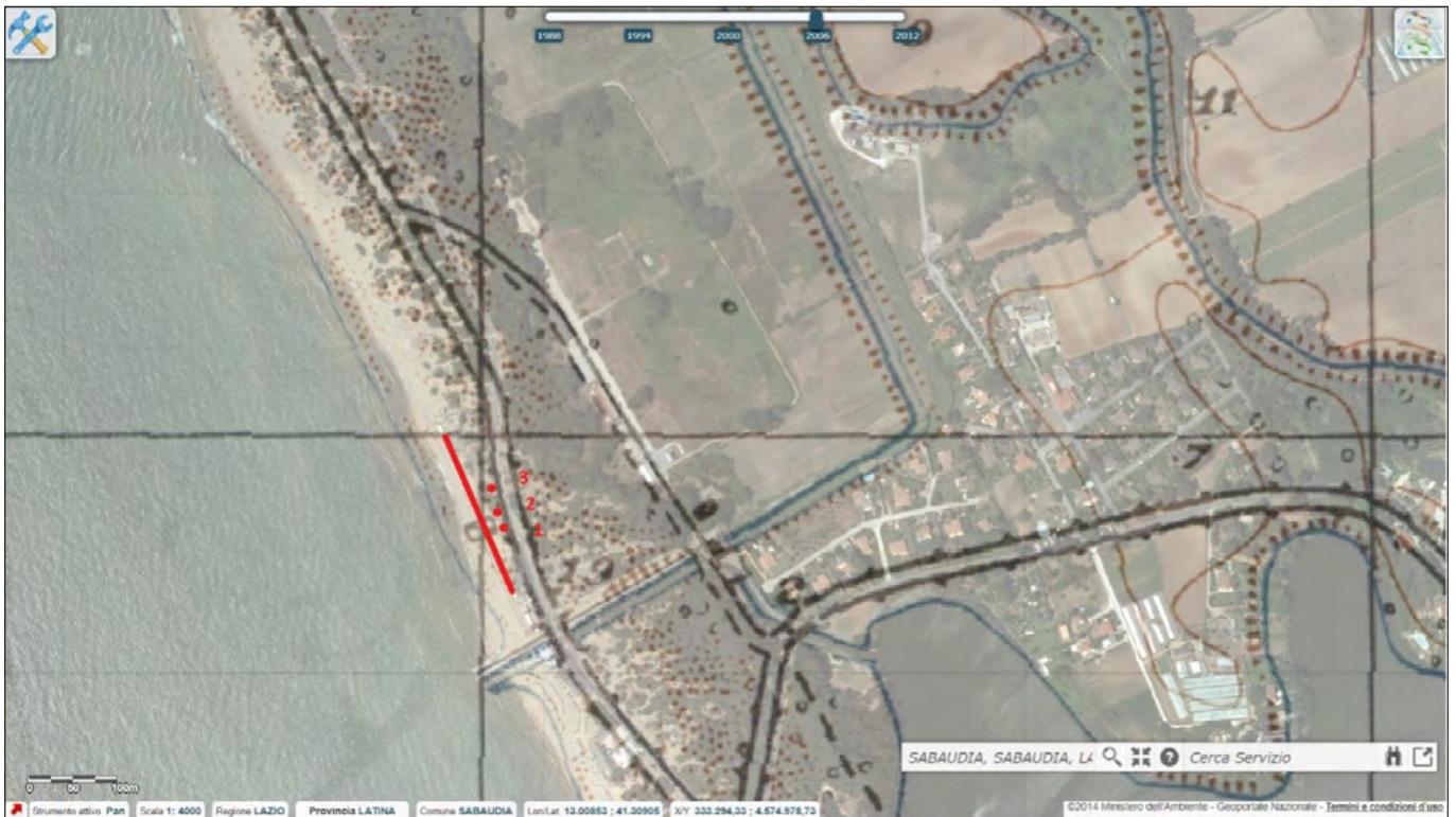
Figura 3. Ortofoto del litorale sovrapposta a carta IGM con evidenziazione dell'arretramento della spiaggia e indicazione del tratto interessato agli interventi di riqualificazione
