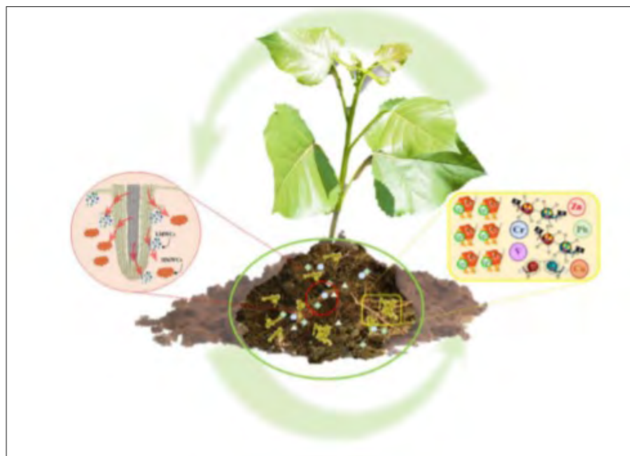
Figura 1. Interazioni tra gli essudati radicali delle specie vegetali e le comunità microbiche autoctone presenti nel suolo che danno il via ai processi che sono alla base della tecnica del PABR per il risanamento di aree contaminate
