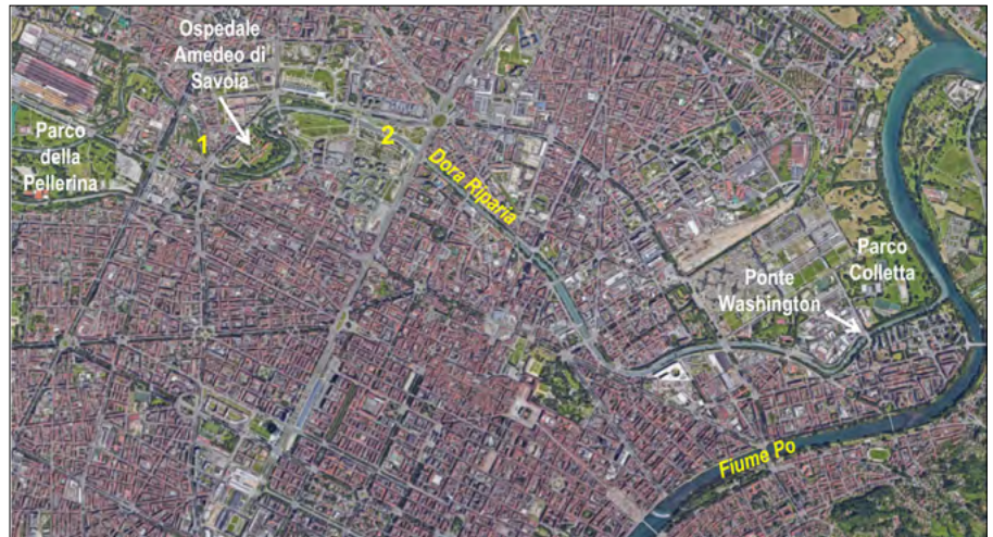
Figura 1. La Dora Riparia nel suo percorso finale attraverso la Città di Torino. I numeri 1 e 2 segnalano le due sezioni fluviali prese in considerazione per le verifiche idrauliche. Sul Ponte Washington è ubicata la stazione idrografica "Dora Riparia a Torino"
