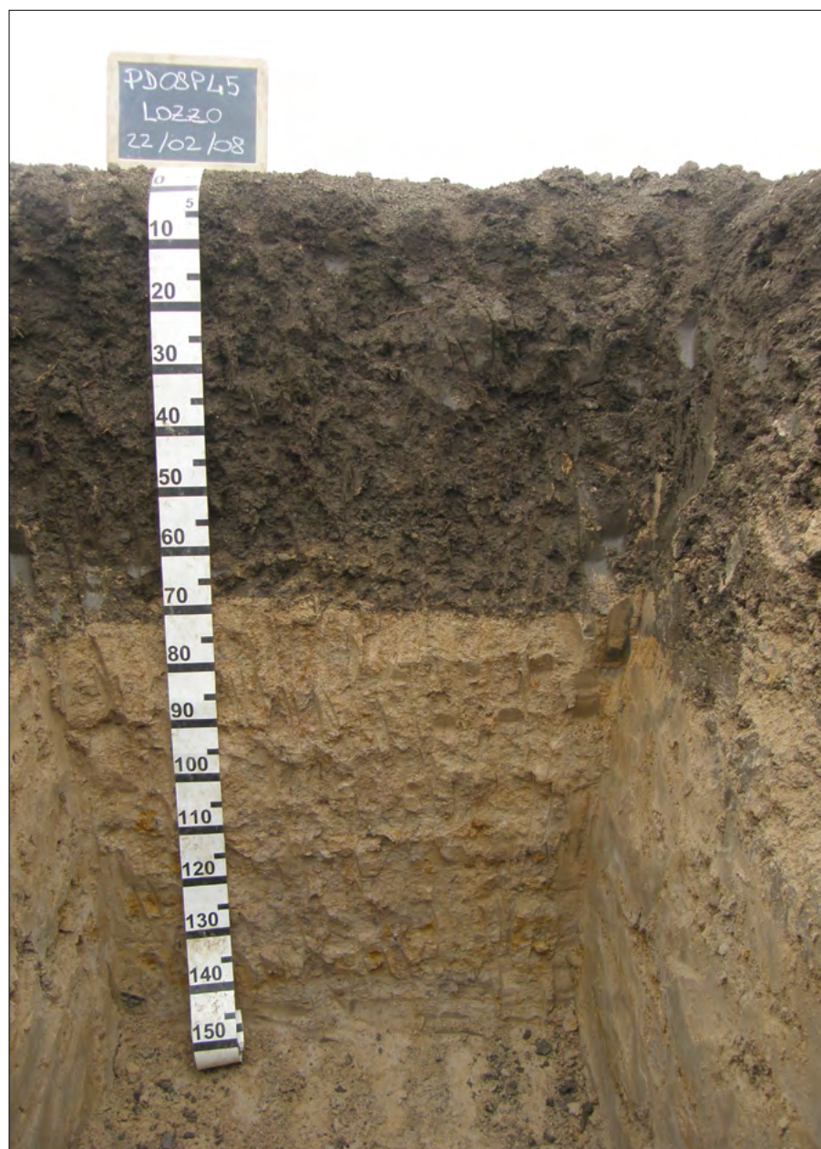
Figura 4. Profilo di suolo della depressione tra le pianure di Adige e Brenta, a difficile drenaggio e accumulo di sostanza organica in superficie
