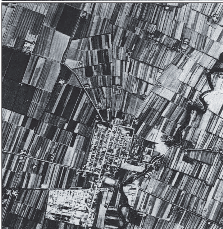
Figura 3 – Situazione geomorfologica caratterizzante l'abitato di Cortemaggiore. È evidente nel disegno e nell'immagine fotografica, la presenza di una antica conoide, collocata subito a valle di un "gomito di deviazione" segnato dal torrente Arda. Nella zona apicale di tale conoide, leggermente sopraelevata rispetto alla pianura circostante, è sorto l'abitato di Cortemaggiore. La formazione del cono di deiezione è presumibilmente da ricollegare a un recente movimento (inarcamento) dell'anticlinale sepolta di Cortemaggiore: il torrente Arda ha inizialmente tentato di aprirsi un varco all'interno della "gibbosità" in via di accrescimento, depositando a valle i materiali erosi (e quindi formando la conoide); successivamente ha trovato più comodo deviare il proprio percorso, con ciò non costituendo più un pericolo (Fonte: Marchetti, Dall'Aglio, 1990). 1 = nucleo abitato; 2 = conoide; 3 = deviazione (digressione) del torrente Arda; 4 = anticlinale sepolta di Cortemaggiore (dati AGIP).
