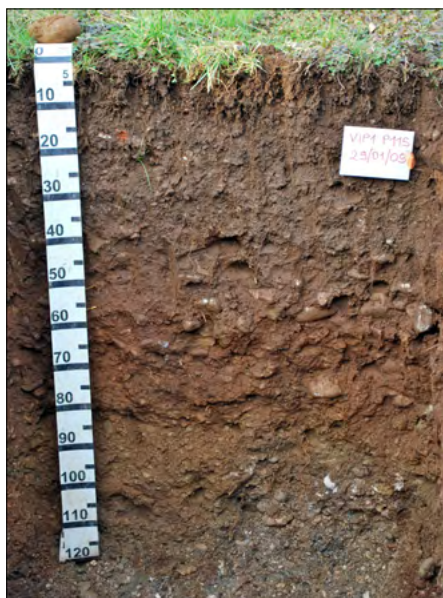
Figura 4a. I suoli dell'alta pianura antica del Brenta (B1) presentano un orizzonte di accumulo illuviale di argilla al di sopra del substrato sabbioso-ghiaioso
