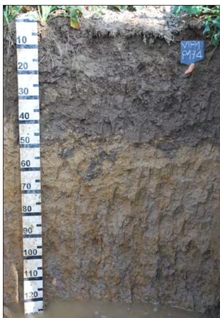
Figura 5b. I suoli della bassa pianura recente (B5, piana di divagazione a meandri) sono meno decarbonatati rispetto a quelli della superficie antica e presentano orizzonti di accumulo di carbonati negli orizzonti profondi meno espressi
