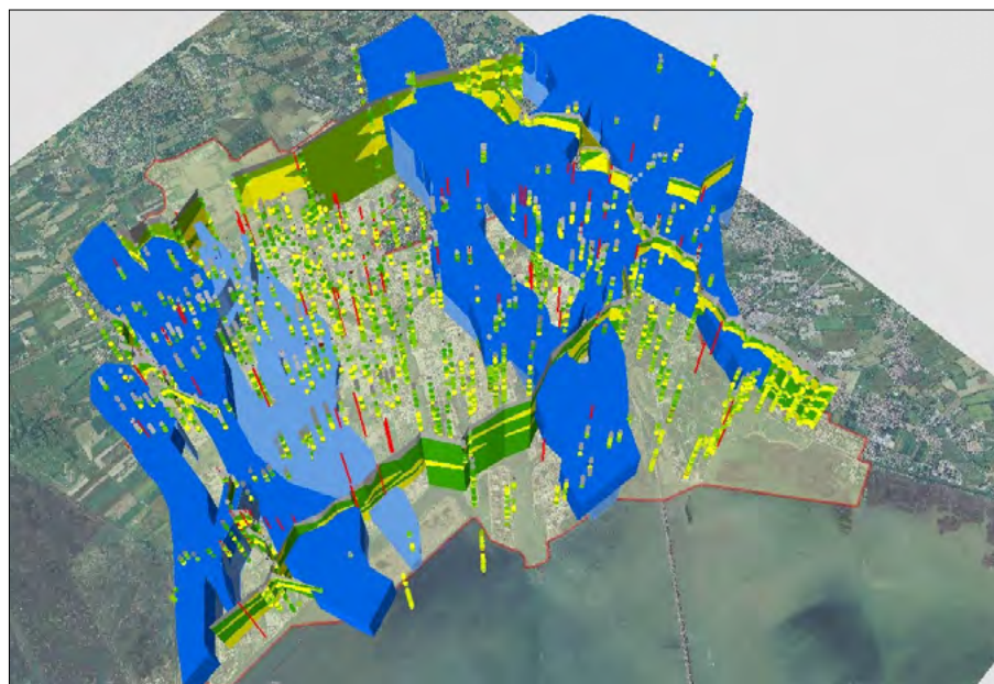
Figura 1. Esempio di modello geologico in area di bassa pianura. Schematizzazione del sottosuolo dell'area di Porto Marghera. In azzurro i corpi permeabili (acquiferi). (da Vitturi et alii, 2011)
