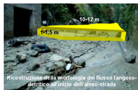
Figura 14. Ricostruzione della morfologia di una colata di fango e detriti al passaggio tra vallone naturale e vallone urbanizzato. In base alle tracce e alla stima della velocità si valuta che la portata massima della parte frontale del flusso potesse essere compresa tra i 200 e 300 mc/sec, di gran lunga superiore a quella che poteva essere smaltita dalla fognatura per cui il flusso ha continuato la sua rapida discesa lungo la strada. È evidente il materiale che era stato scaricato abusivamente nella valle a monte (es. il pneumatico)
