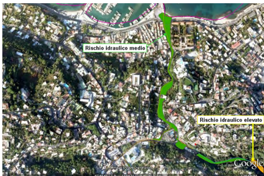
Figura 19. Stralcio della carta del rischio idraulico elaborata nell'ambito del Piano Stralcio per l'Assetto Idrogeologico dell'Autorità di Bacino Nord Occidentale della Campania. Come si può notare solo una parte delle strade che sono state percorse dai flussi fangosi nell'area abitata sono stati cartografati come aree a rischio idraulico medio. Parte degli alvei strada devastati dai flussi fangosi non sono a rischio idraulico
