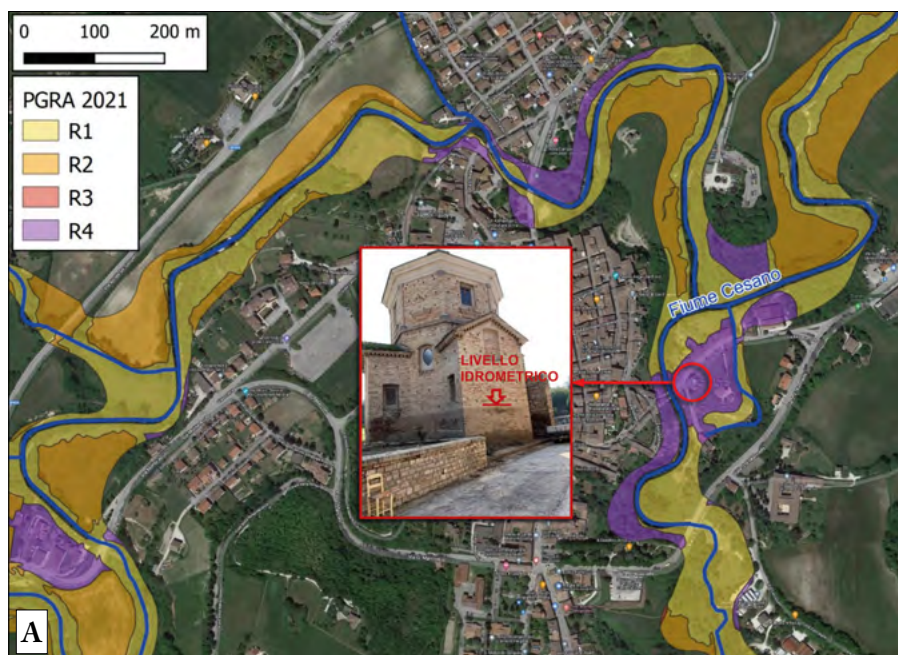
Figura 8 A/B/C. Rappresentazione del reticolo idrografico in relazione al livello di rischio PGRA 2021 a Pergola con focus del livello idrometrico raggiunto dal colmo di piena (fiume Cesano) in corrispondenza della Chiesa di S. Maria delle Tinte gravemente danneggiata con altre immagini nell'intorno del ponte (interferenza reticolo/infrastruttura)
