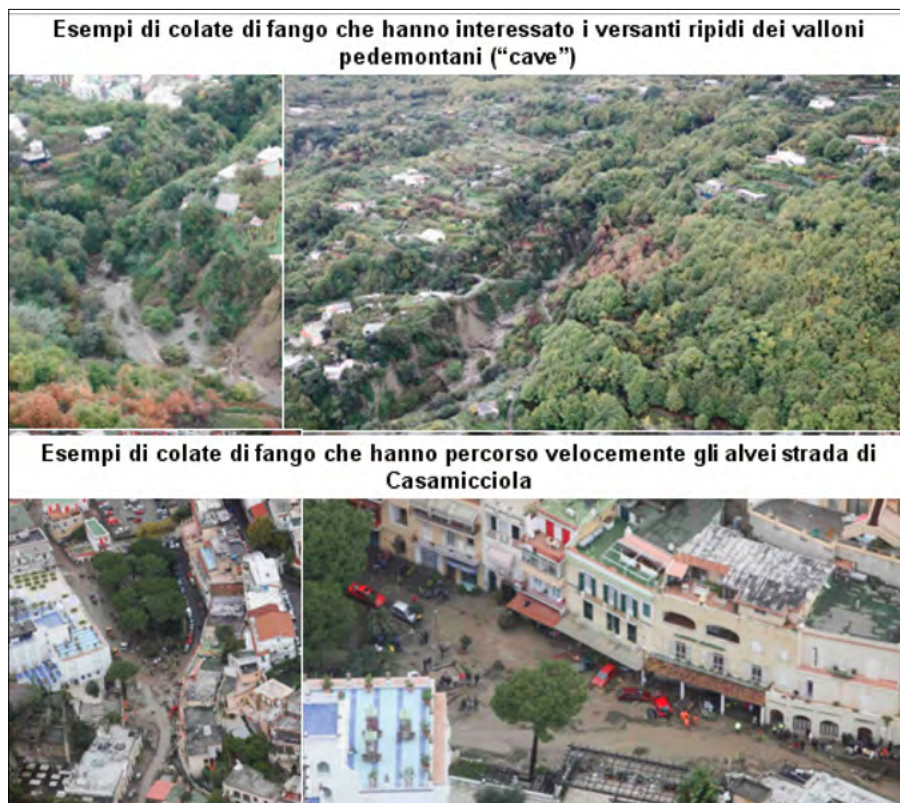
Figura 12. Esempi di colate rapide di fango, causate dalla pioggia del 10 novembre 2009, lungo i ripidi versanti dei valloni pedemontani (in alto). La fascia pedemontana nelle ultime decine di anni è stata sensibilmente interessata dalla realizzazione di nuovi edifici, strade, modellamenti del terreno, scarico di materiale lungo i versanti e nei valloni. Lo smaltimento delle acque superficiali è avvenuto mediante interventi "spontanei" non coordinati in maniera da garantire la sicurezza ambientale. In basso, esempi delle tracce lasciate dai flussi fangosi lungo le strade urbane trasformate in alvei-strada
