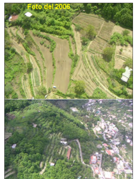
Figura 10. Esempi di terrazzamenti agricoli nella fascia pedemontana a monte dell'abitato di Casamicciola. In occasione di intensi eventi piovosi, se le sistemazioni idraulico-agrarie e lo smaltimento delle acque di ruscellamento non sono realizzati bene, tali aree sono interessate da attivi e rapidi fenomeni erosivi che determinano diffusi dissesti e l'afflusso di notevoli volumi di acqua fangosa negli alvei che possono causare l'innescio di flussi fangosi rapidi incanalati
