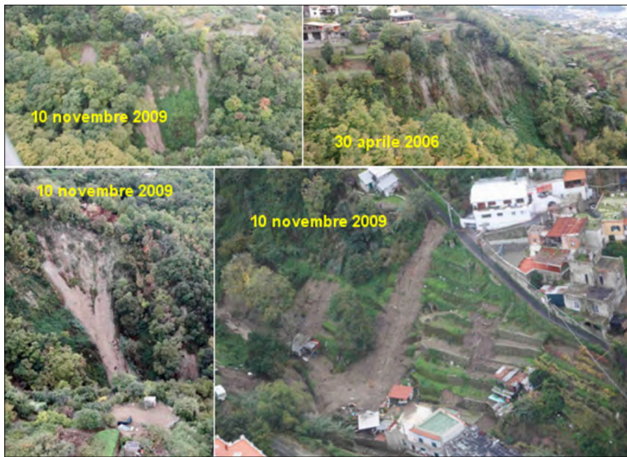
Figura 8. Esempi di colate rapide di fango causate, dalla pioggia del 10 novembre 2009, lungo i ripidi versanti dei valloni pedemontani. La foto in alto a destra evidenzia alcune colate di fango originatesi in seguito alle piogge del 30 aprile 2006
